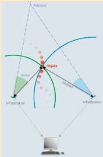
Mit Hilfe von Techniken wie Winkel- oder Laufzeitmessung kann man die Position eines Objekts ermitteln.
