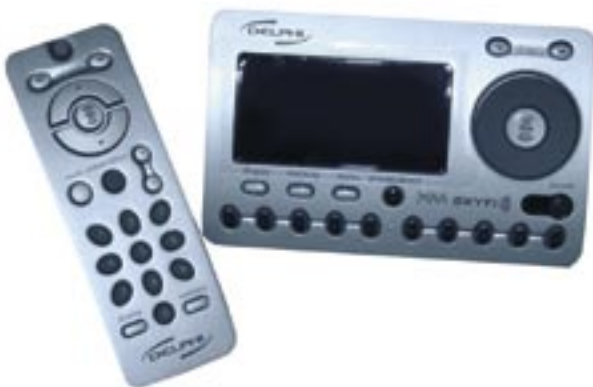
Bild 3: Prototyp einer Satelliten-Naviga- tions-Plattform: Die Signalverar- beitung läuft auf einem anwen- dungsspezifischen eingebetteten Prozessor.
