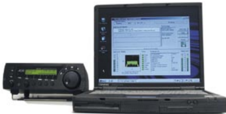
Bild 1: Digital Radio Mondiale (DRM): Ausgehend von einer ausführbaren Spezifikation (Fraunhofer DRM Software Radio), wurde ein Hardware-IP mit spezialisierten Recheneinheiten implementiert.
