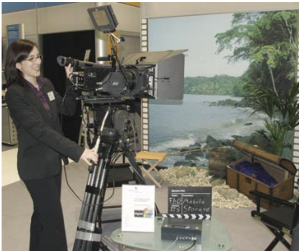
Bild 1: Hochwertigeameratechnik für Film und Fernsehen: Digitale Filmkamera ARRI-D20
