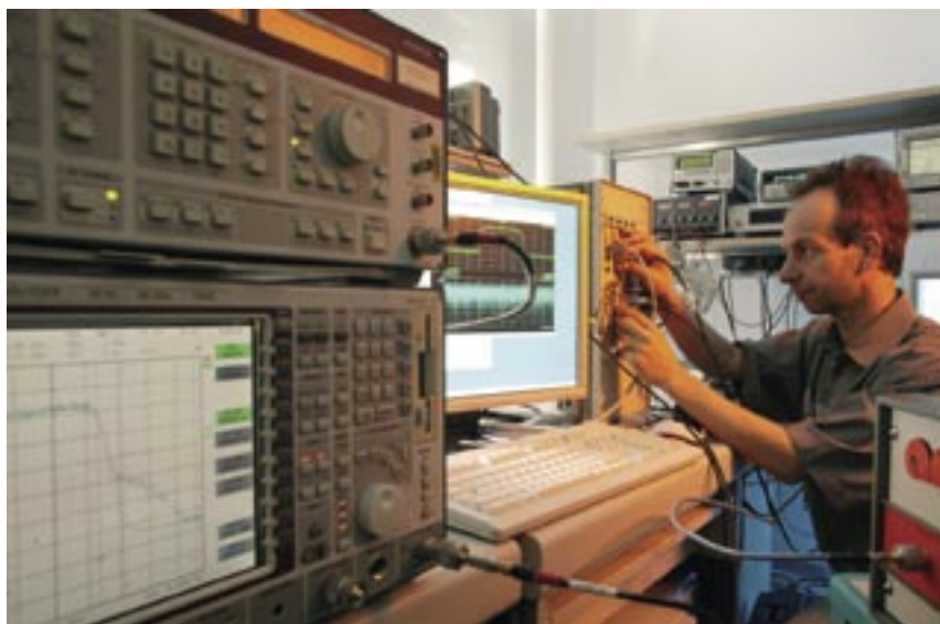
Bild 1: Linearisierung eines Leistungsverstärkers für UMTS Basisstationen
