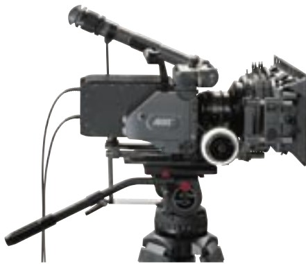
Bild1: Digitaler D20-Kamerademonstrator: Kombination aus Komponenten einer Filmkamera und digitaler Kameraelektronik
