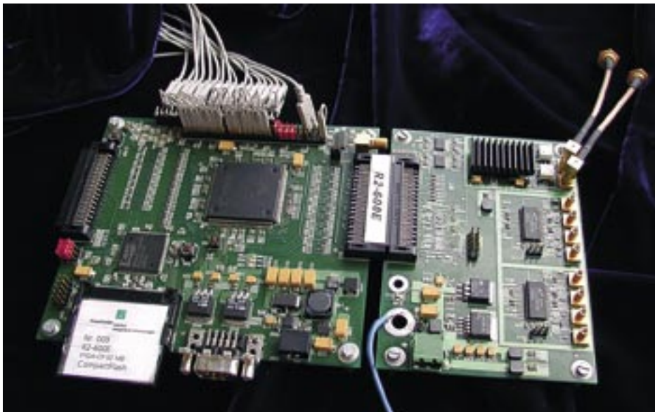
Bild 2: FPGA-Board: Skalierbare und rekonfigurierbare Hardware für Labor- und Feldtests Figure 2: FPGA board: Scalable and reconfigurable hard- ware for laboratory or field tests
