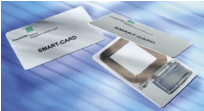
Bild 3: Chipkarte mit integriertem Chip, Spule und Li-Akku Figure 3: Smart card with integrated chip, coil and lithium battery
