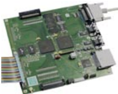
Bild 3: Prototyp einer Satelliten-Naviga- tions-Plattform: Die Signalverar- beitung läuft auf einem anwen- dungsspezifischen eingebetteten Prozessor.
