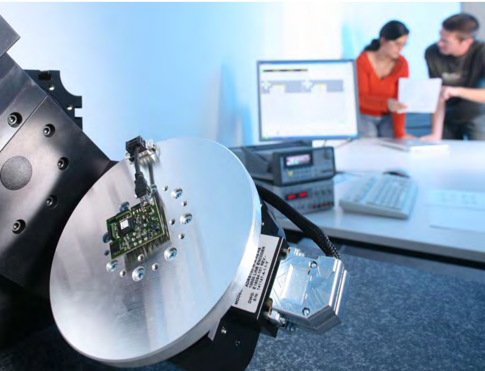
Wissenschaftler des Fraunhofer IIS kalibrieren die Inertialsensoreinheit auf einem mehrachsigen Rotationstisch Fraunhofer IIS scientists are calibrating the inertial measurement unit on a multiaxial rotary stage
