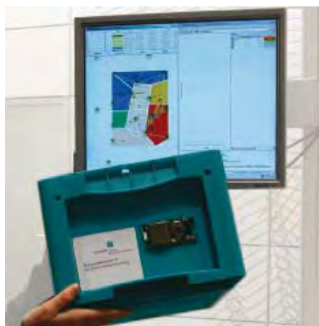
Behälter mit Sensorknoten Container with sensor node
