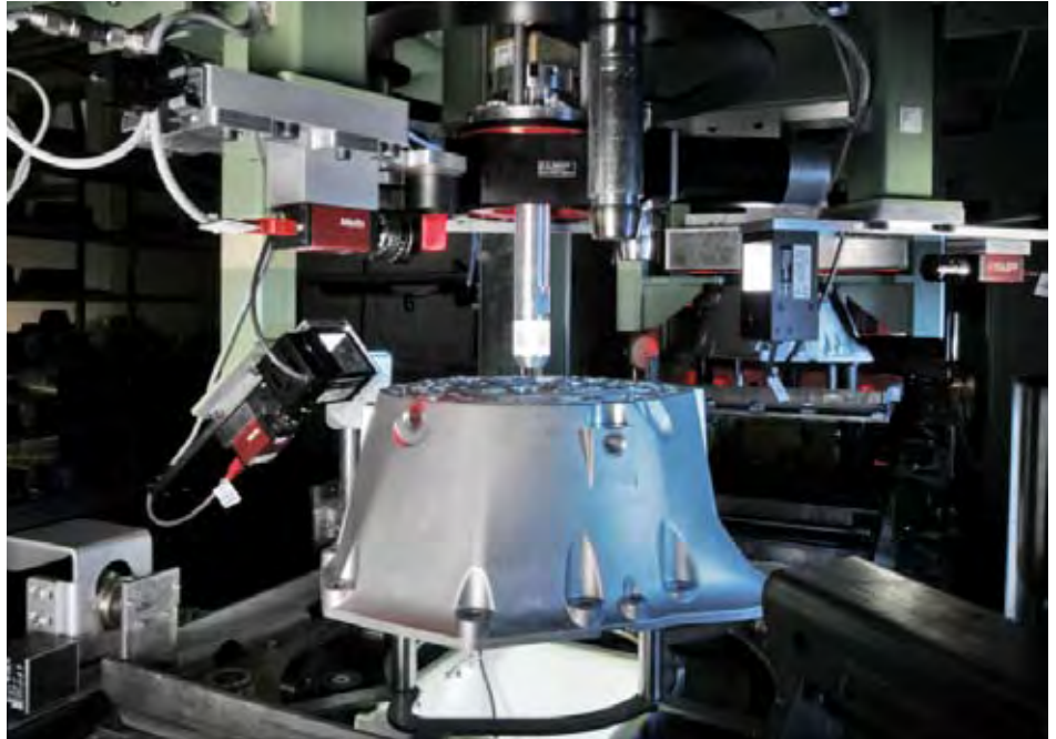
Bild 1: Optische Prüfung des Wandlergehäuses eines Automatikgetriebes Figure 1: Optical inspection of the casing of an automatic gearbox
