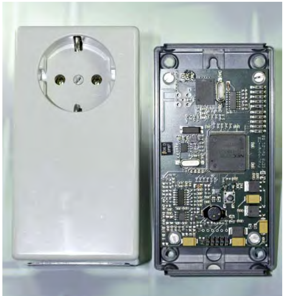
Zwischenstecker mit Leistungsmessmodul und Funkdatenübertragung Adapter with power meter and wireless data transmission
