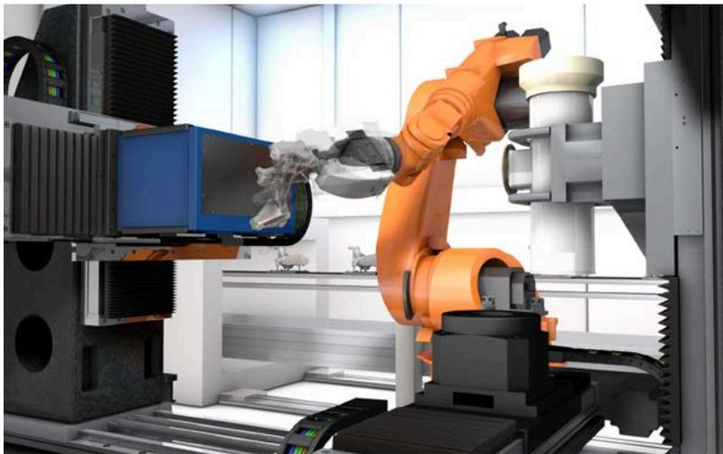
**Die neuentwickelte DRAGONFLY-Röntgentechnologie reduziert die Prüfzeit von Gussteilen um die Hälfte. © Fraunhofer IIS | Bild in Farbe und Druckqualität: [www.iis.fraunhofer.de/pr](http://www.iis.fraunhofer.de/pr).**
