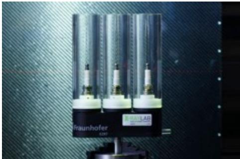
Messreihen können mit »PolyCT« bis zu dreimal schneller geprüft werden. Im Bild wurde das Nachrüst-Kit mit drei Zündkerzen bestückt. ©xray-lab
