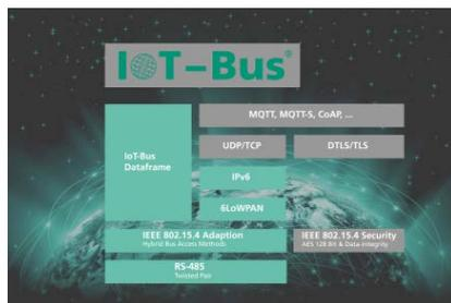
**Mit dem IoT-Bus sicher ins Internet der Dinge – Softwarestruktur ©Fraunhofer IIS/Fotolia.com-Victoria | Bild in Farbe und Druckqualität: [www.iis.fraunhofer.de/pr](http://www.iis.fraunhofer.de/pr).**
