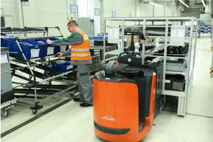
**Pick-by-Local-Light in der Erprobung bei Volkswagen: Das PbLL führt den Mitarbeiter visuell durch den Kommissionierungsprozess und zeigt auf einem Display die zu entnehmende Menge an.**
