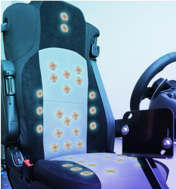
Die kapazitiven Bewegungssensoren des Fraunhofer IIS wurden für die Erfassung des Bewegungsverhaltens der Berufskraftfahrenden in den Sitzbezug des »Mobilization Seats« integriert. Die Abbildung zeigt eine Fotomontage der Sensorpositionen unterhalb des Bezugs. © Fraunhofer IIS/Jakob Wagenbrenner | Bild in Druckqualität:
