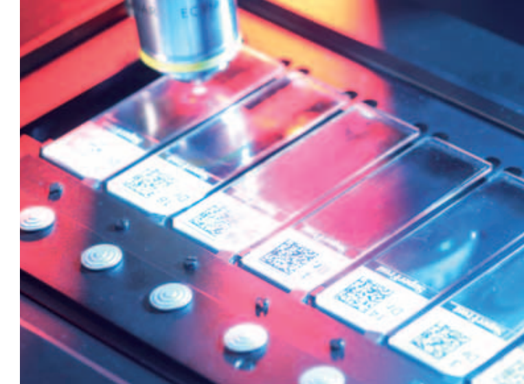
Effizienter arbeiten. Mit HemaCAM® können bis zu 8 Blutproben nacheinander analysiert werden.
