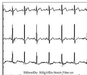
Abb. 4 Nachweis der Signalgüte am Beispiel einer EKG-Ableitung am Probanden nach Einthoven.
