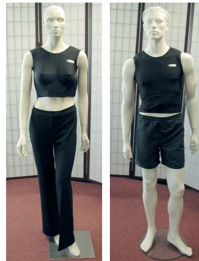
Abb. 5 Sensorshirt mit integriertem EKG- Modul für die Frau und für den Mann.
