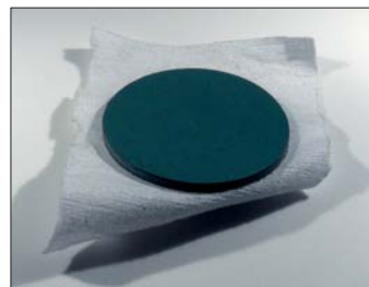
Abb. 3 Flexible, textilintegrierte Oberflächenelektrode.
